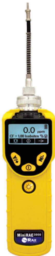
FIGURE 2.5.2. MiniRAE 3000 portable PID
